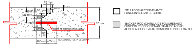
DETALLE DE JUNTA DE CONSTRUCCION
